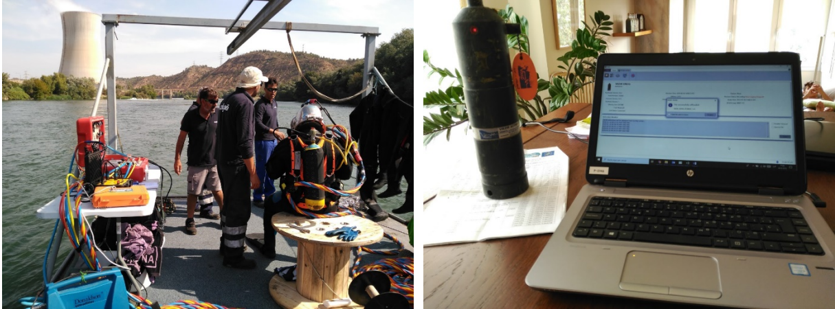
Figura 10. Operació de recuperació dels receptors VEMCO al riu Ebre amb el suport d'un bus, el setembre de 2018 (a l'esquerra), i procés de descàrrega de dades d'un receptor a un ordinador portàtil per Bluetooth (a la dreta).
