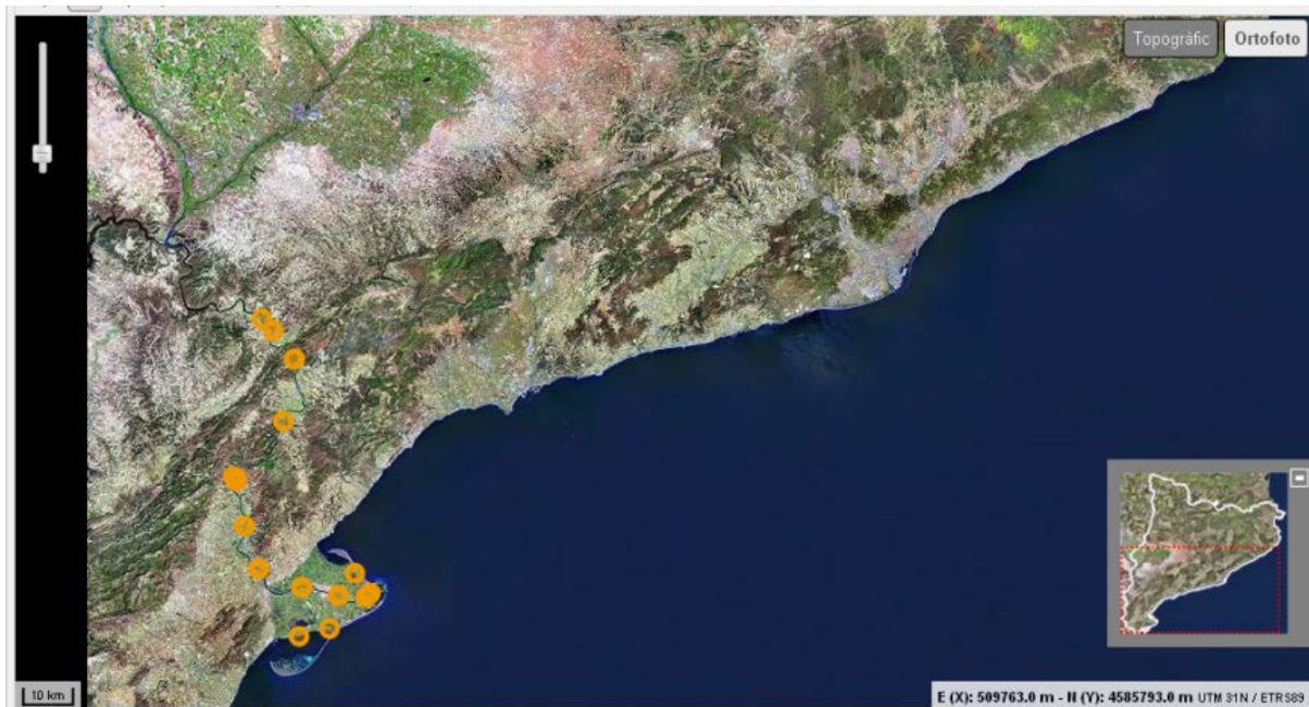
Figura 4. Distribució de les diverses estacions de receptors VEMCO VR2W-69kHz, de detecció, per mitjà de sistemes de telemetria ultrasònica, del pas dels peixos marcats al tram final del riu Ebre, instal·lades entre el maig de l'any 2017 i el setembre de 2018.
