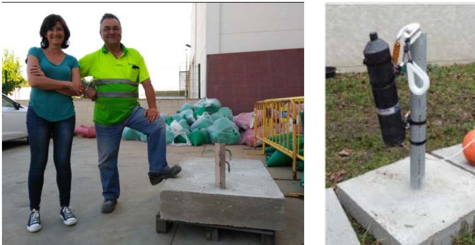
Figura 5. Mostra dels morts i com hi van estacats els receptors de VEMCO VR2W-69kHz, de detecció, per mitjà de sistemes de telemetria ultrasònica, del pas dels peixos marcats al tram final del riu Ebre, instal·lats a partir del maig de l'any 2017 i fins al setembre de 2018.
