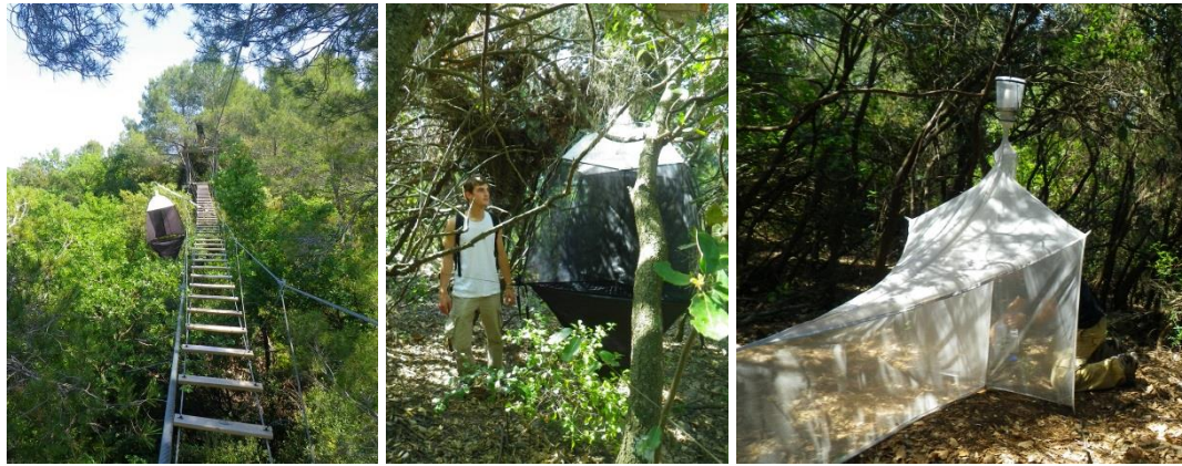
Figura 8. Trampas utilizadas en este estudio: Malaise Aérea de intercepción en el dosel y en el sotobosque y trampa Malaise Townes, también en el sotobosque.
